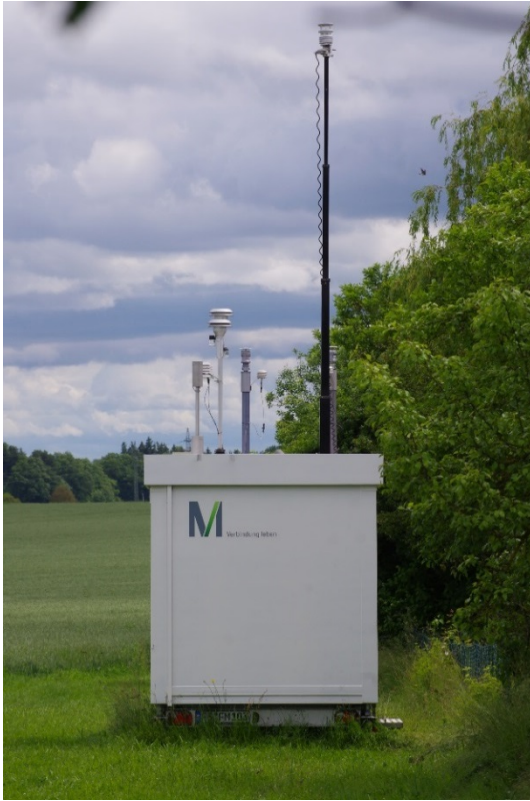
Abbildung 10. Außenansicht der mobilen Luftgütemessstation am Standort „östlich Mischgebiet“ in Haimhausen.
