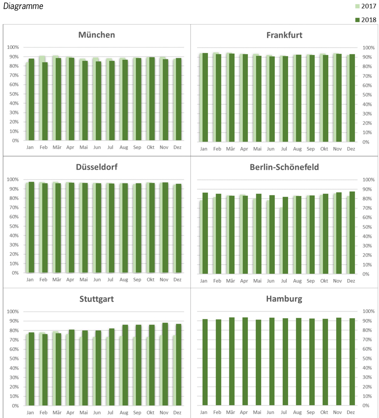
Abb. 5: Anteil der IFR-Abflüge mit Anlassfreigabe per Funk innerhalb TSAT \pm 5 min für 2018 (dunkelgrün) und 2017 (hellgrün)
