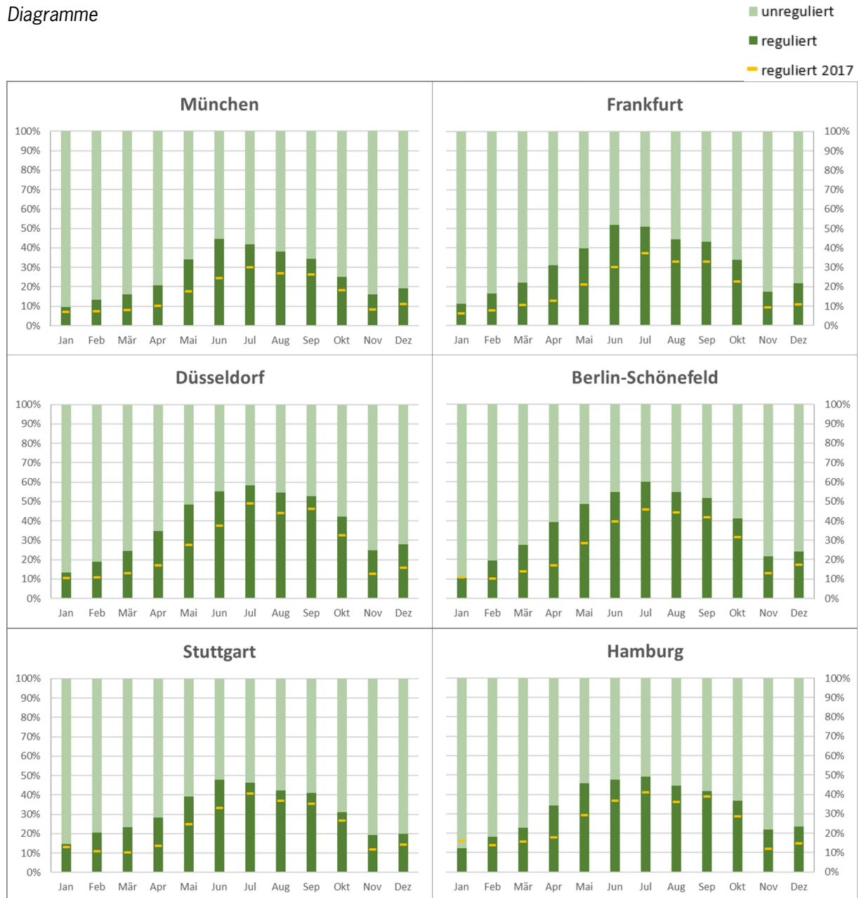
Abb. 3: Verhältnis unregulierter (hellgrün) zu regulierten (dunkelgrün) IFR-Abflügen 2018 und Anteil regulierter Flüge 2017 (gelb)
